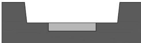
**Canais de drenagem lineares destinados a recolher e a transportar as águas de drenagem superficial**
